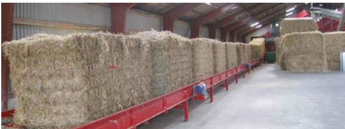
Варианты автоматизированных транспортных систем для подачи тюков соломы на измельчитель(дробилку). Подача тюков соломы.
