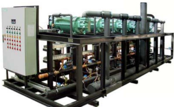
В качестве компрессорного блока предлагается многокомпрессорный агрегат серии АМ на базе винтовых компрессоров "BITZER", предназначенный для работы с хладагентом R507. Предлагаемая холодильная машина выполнена на базе шести низкотемпературных винтовых компрессоров серии HSN 74, с установленными на нём запорными вентилями на всасывании и нагнетании. Каждый компрессор оснащён разборным фильтром на всасывании и фильтром на линии экономайзера.
