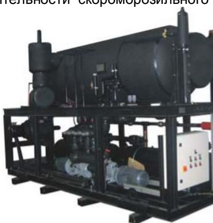
Подача хладагента насосом с кратностью циркуляции 4...6 обеспечивает максимальную их эффективность работы испарителя, ввиду отсутствия перегрева. Не испарившийся хладагент поступает обратно в насосно-циркуляционный ресивер. Выпарившийся хладагент из этого ресивера отсасывается компрессорами.
