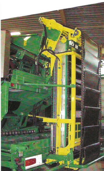
Bunker opvoer elevator. in-feed elevator. Überladeelevator. Elevateur trémie.
