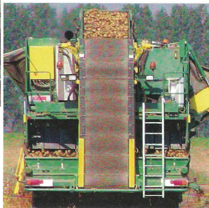
Bunker opvoer elevator. in-feed elevator. Überladeelevator. Elevateur trémie.
